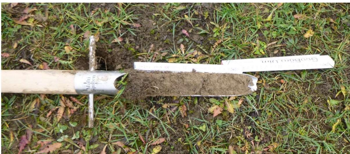
**Abbildung 3** Bohrstock zur Gewinnung der Oberbodenproben
